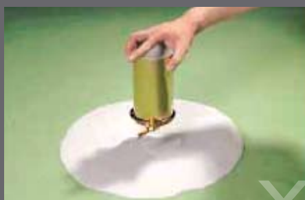
6. Се подесуваат параметрите во машината се до добивање на саканата конзистенција на естрихот.
